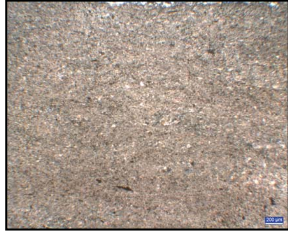
Şekil 17: İnce taneli killi yan kayaçta (hafif yönlenme gösteren metasilttaşı: metaşeyl); serisit, klorit, ince taneli kuvars ve feldispatların dağılımı (Tek nikol).
